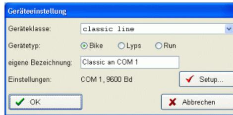
Wählen Sie in der Geräteklasse **classic line** oder **space line** und den entsprechenden Gerätetyp auf **Bike**, **Lyps** oder **Run**. Zum Ändern der Kommunikationseinstellungen betätigen Sie jetzt den Schalter „Setup“.
