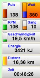
In den Werteanzeigen werden die aktuellen Trainingswerte angezeigt. Wird ein eingestellter Grenzwert überschritten, so färbt sich das entsprechende Feld orange/rot und es ertönt ein Signalton.
